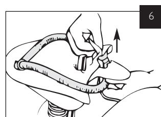
Schlauch aus dem Schlitz der Lungenplatte herausziehen und kompletten Luftweg entfernen. Luftweg entsorgen.
