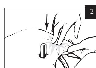
Presionar sobre el conector del pulmón hasta que enganche completamente en la placa del pulmón. Asegurarse de que el pistón de ventilación pueda moverse libremente.
