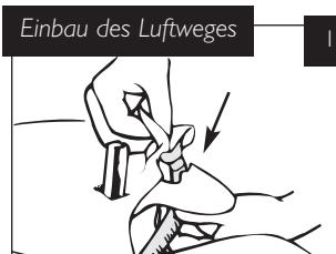
Expirationsschlauch auf der Lungenplatte platzieren und durch den seitlichen Schlitz ziehen.
