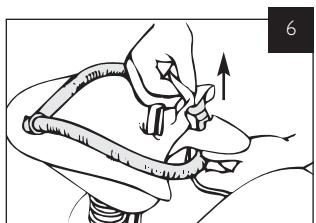
Schuif de slang door de opening in de longplaat om het luchtwegsysteem los te maken;
