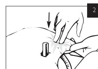
Druk op de longconnector tot deze goed aan de longplaat is bevestigd. Zorg er voor dat de ventilatieglijder vrij kan bewegen;
