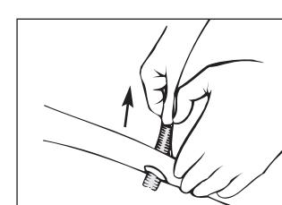
Expirationsschlauch aus der seitlichen Öffnung ziehen.
