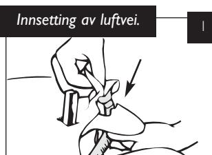
Tre slangen, med lungen øverst, gjennom sporet i lungeplaten.
