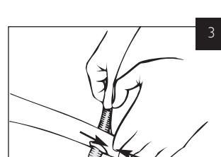
Presionar el tubo de espiración en el sujetador lateral hasta que el extremo sobresalga cerca de 2,3 cm.
