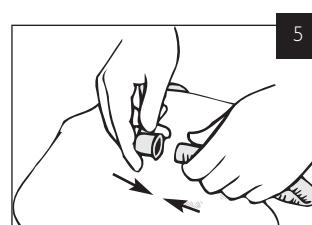
Tre utblåsingsslangen inn på innblåsingsslangens koplingsstykke.
