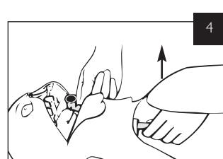
Insérer le tuyau d'inspiration à travers le cou et connecter le raccord des voies respiratoires dans son support.
