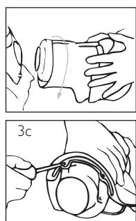
3. a) Haltebänder an der Halsrückseite lösen.
