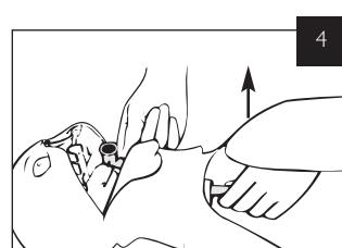
Inspirationsschlauch durch die Halsöffnung führen und den Luftwegekonnektor auf den Halter im Kopf stecken.
