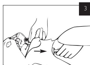
Lossa luftevakueringsslangen från hållaren i öppningen i dockans sida.
