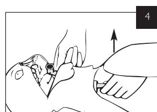
Skyv innblåsingsslangen opp gjennom treningsdukkens hals, og trykk luftveiskoplingen på plass i holderen.
