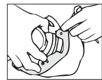
**Het vervangen van de kraag met hartslagsimulator****Het verwijderen:**
