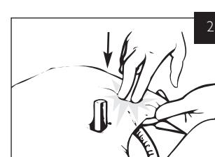
Skyv lungens koplingsstykke på plass i åpningen i lungeplaten. Påse at ventilasjonsarmen kan beveges fritt.
