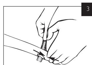
Skjut ut luftevakueringsslangen genom dess hållare, så att änden når ca 2-3 cm utanför öppningen i dockans sida.
