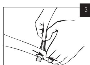
Skyv utblåsingsslangens ende ca 2-3 cm ut gjennom åpningen i treningsdukkens side.
