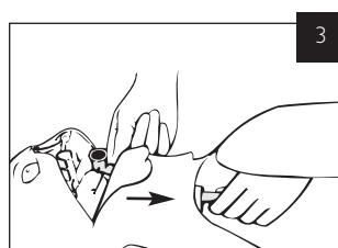
Détacher le raccord des voies respiratoires et tirer le tuyau d'inspiration à travers le cou vers l'intérieur du mannequin.
