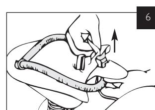
Deslizar los tubos a través de la ranura de la placa del pulmón para desenganchar el conjunto vía respiratoria. Desechar la vía respiratoria utilizada.
