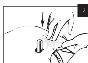
Se till att lungans kopplingsstycke trycks riktigt i lungplattan. Se till att ventilationsglidaren kan röra sig fritt.
