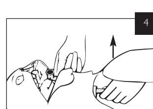
Deslizar el tubo de aspiración a través del cuello y enganchar el conector de vía respiratoria en su sujetador.
