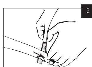
Expirationsschlauch durch die seitliche Öffnung schieben, bis dieser ca. 2-3 cm herausragt.
