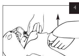
Skjut upp luftvägsslagen genom dockans hals och tryck fast luftvägskopplingen i hållaren.
